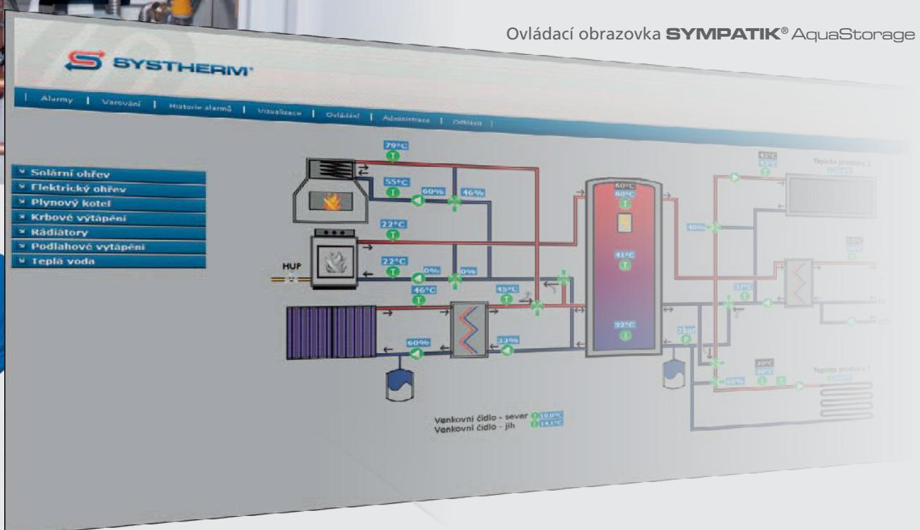
K zařízení **SYMPATIK®** AquaStorage připojíte nejrůznější energetické vstupy a ty se potom optimalizované rozvádějí do jednotlivých topných systémů
